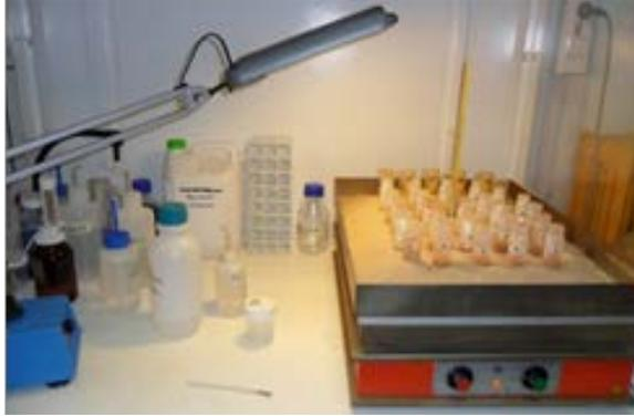
**Figure 16.a.** Oxydation à H<sub>2</sub>O<sub>2</sub> sur bain de sable
