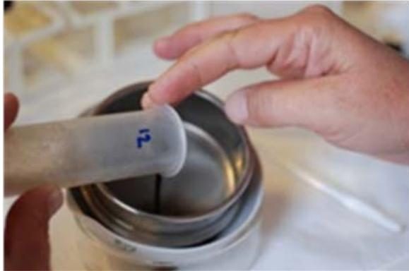
**Figure 18.a.** Tamisage des échantillons
