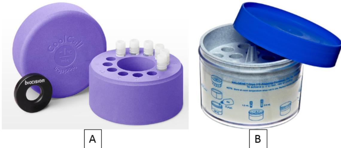
FIGURE 5 – **Boîtes de cryogénération de cellules.** A : CoolCell® (biocision™) ; B : Mr. Frosty® (Nalgene™).
