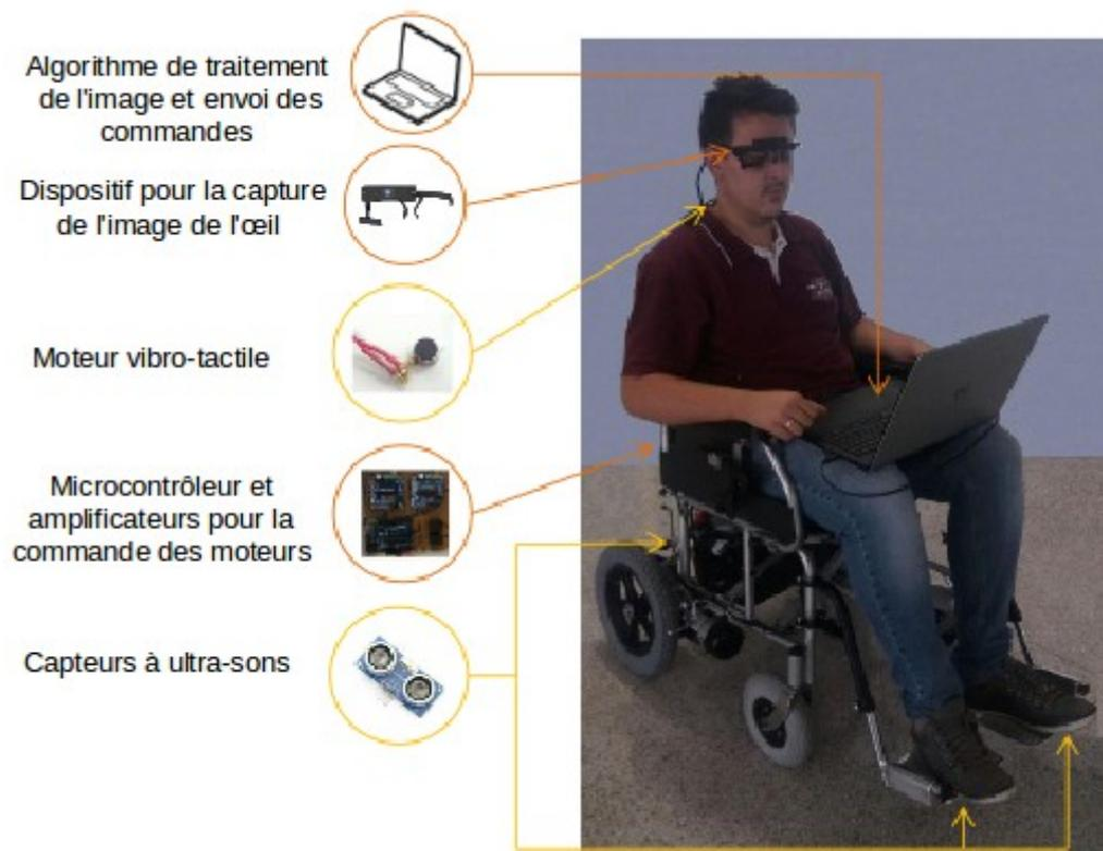
**Figure 5** : Photo du dispositif utilisé avec le système *Pupil-MatLab*.
